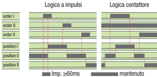
Per permettere il controllo, chiudere il contatto 312 con il 317. Per assegnare la logica contattore, chiudere il contatto 316 con il 317. Per raggiungere la posizione desiderata, chiudere il contatto corrispondente. Per forzare il dispositivo in posizione 0 primario, chiudere il contatto 313 con il 317.
