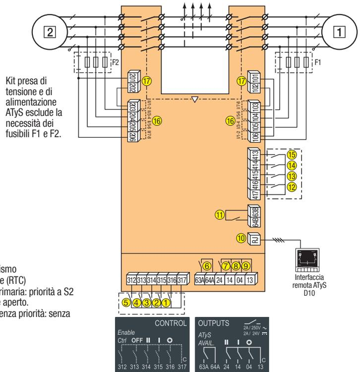
Kit presa di tensione e di alimentazione ATyS esclude la necessità dei fusibili F1 e F2.
