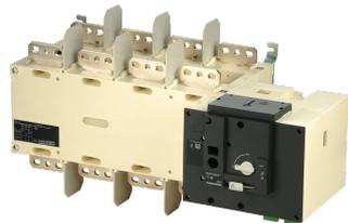
Gli ATyS r sono commutatori di sorgenti, tripolari e tetrapolari, a comando motorizzato manovrati a distanza e con apertura completamente apparente. Assicurano la commutazione sotto carico e telecomandata tra due sorgenti trifase, attraverso contatti puliti provenienti da un automatismo esterno, seguendo una logica ad impulsi o a contatto mantenuto. Sono destinati a essere utilizzati in reti elettriche a bassa tensione offrendo tre posizioni stabili (I, 0, II).
