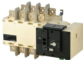
Gli ATyS r sono commutatori di sorgenti, tripolari e tetrapolari, a comando motorizzato manovrati a distanza e con apertura completamente apparente. Assicurano la commutazione sotto carico e telecomandata tra due sorgenti trifase, attraverso contatti puliti provenienti da un automatismo esterno, seguendo una logica ad impulsi o a contatto mantenuto. Sono destinati a essere utilizzati in reti elettriche a bassa tensione offrendo tre posizioni stabili (I, 0, II).
