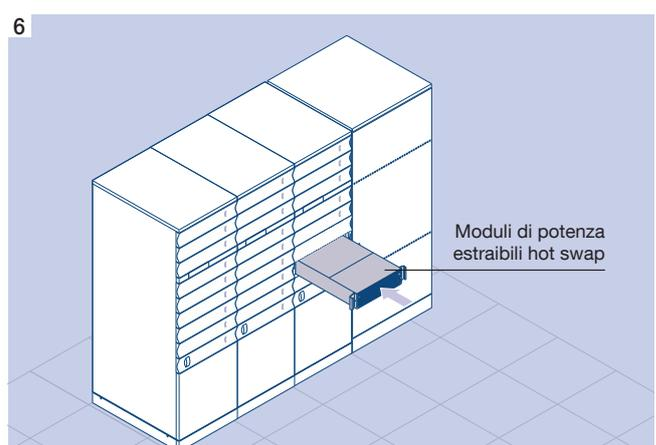
Moduli di potenza estraibili a caldo ("hot-swap") a configurazione automatica e con funzione di autodiagnosi.
