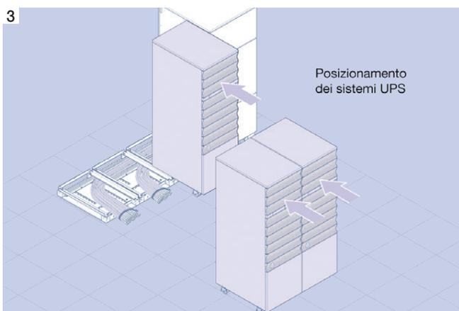
Gli armadi sono facili da spostare (non è necessario un carrello transpallet), posizionare e assemblare.
